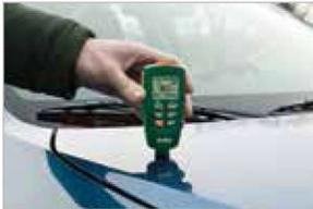
**Reconnaissance automatique des substrats ferreux et non ferreux ; interface USB et logiciel pour transfert vers un ordinateur et analyse des résultats**
